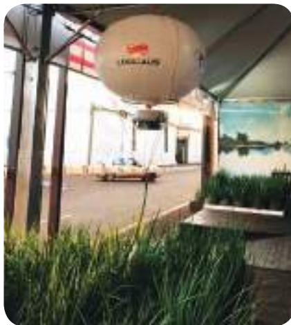
Protótipo de balão que substitui uma infraestrutura de torre fixa de celular
