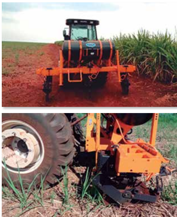
Figura 1. Implemento testado para a aplicação dos tratamentos; detalhe do disco de corte trabalhando sobre a linha da cultura
