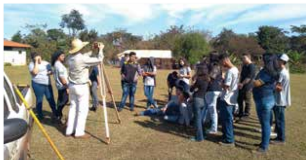
A atividade prática contou com o uso de equipamento de nível óptico
