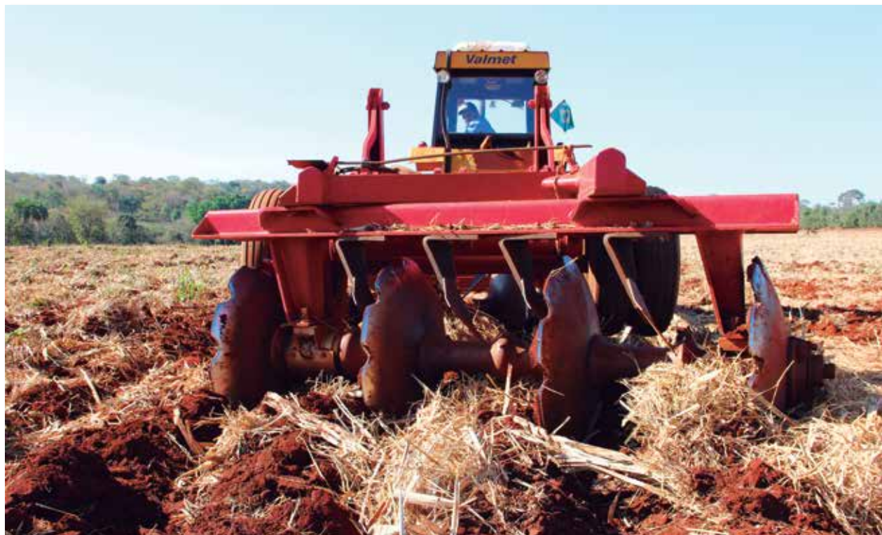
Trator fazendo a gradagem com arado profundo e alternado na área do fornecedor
